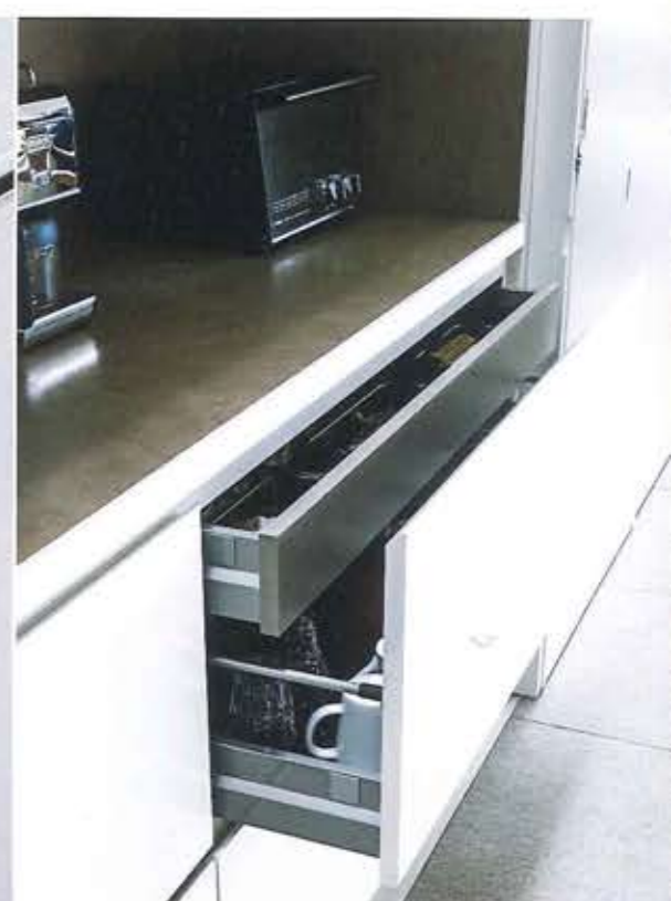
一枚の扉面の大きさが細くなりすぎないように、内側で2段になる引き出しを採用。写真の上段にはSさんが手づくりした仕切り板が。
